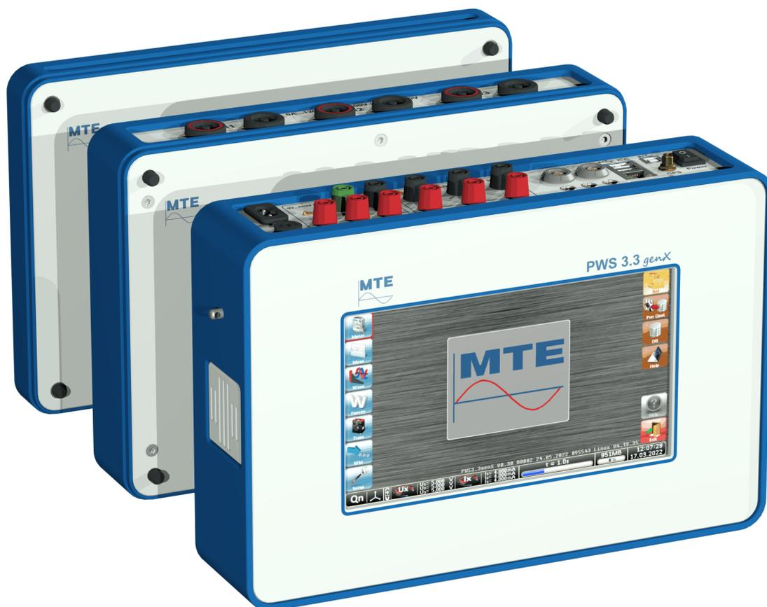
Le PWS 3.3 genX est une combinaison d'un compteur étalon triphasé de classe 0.05 % et un analyseur de qualité d'alimentation selon IEC 61000-4-30 classe A avec 4 canaux de tension (U1, U2, U3, UN, UPE) et 4 canaux de courant (direct : I1, I2, I3 et via un pince de courant : IN / IPE Courant de neutre / Courant de terre de protection).
